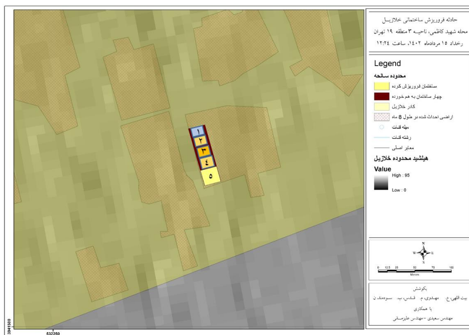
شکل ۱- ترتیب ساختمان‌های به هم برخورد کرده از سمت شمالی (ساختمان بتنی ۱) تا ساختمان ۵ اسکلت فولادی ریزش کرده شمالی
